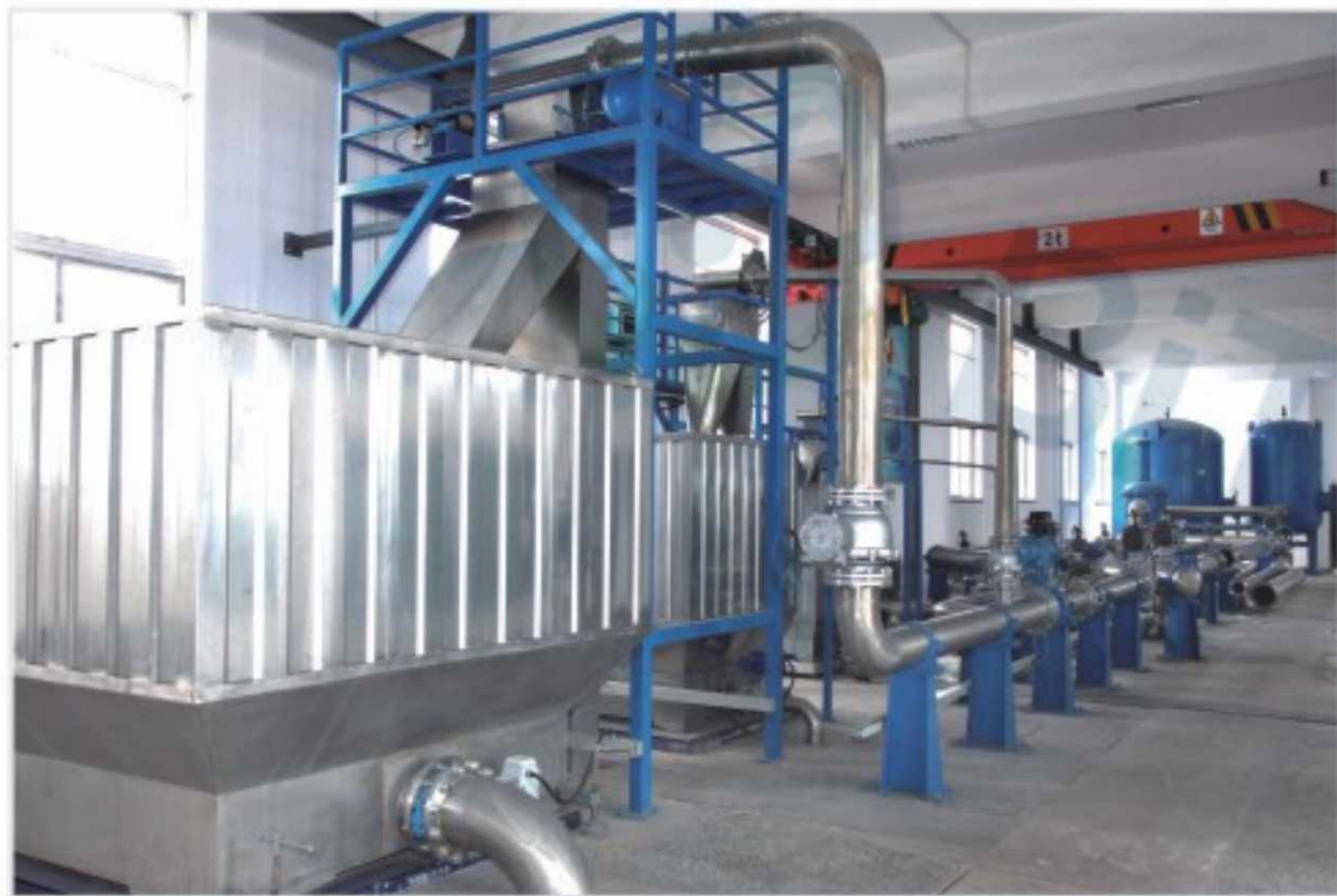
静态质量法/标准表法水流量标准装置
